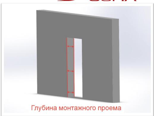
В соответствующую графу бланка внесите информацию по **минимальному** значению высоты, ширины и глубины,полученному при замерах. При отсутствии финишного отделочного слоя (плитка, слой штукатурки и пр.) в графе «Глубина проема» указывается значение фактической глубины проема, плюс толщина финишного/ декоративного слоя.
