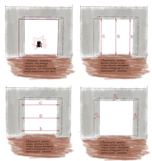
Внесите данные полученных размеров в таблицу, отправьте в салон/вашему менеджеру три полученных значения -высоту, ширину и глубину монтажного проема.
